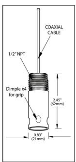
DIN-EL Ext. Cable for DIN Cap Models
