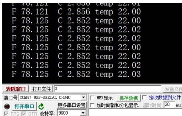
图 5：液位传感模组 LLM 串口输出格式
