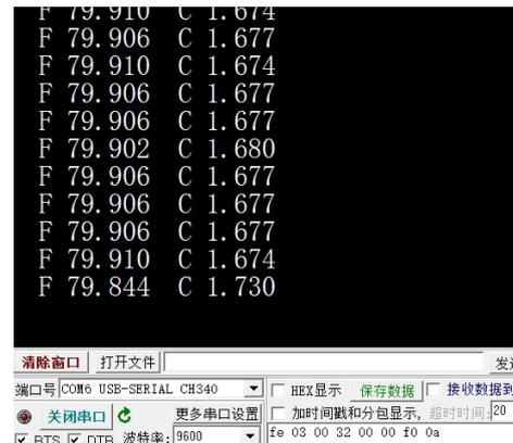
图 6：自配电极液位传感模组 LLM-S 串口输出格式
