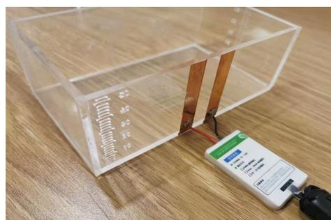
图 4：自配电极液位传感模组 LLM-S 安装方式
